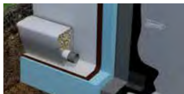
Mur enterrat amb barrera de radó Sistema RAD4 180-40 P Elast
